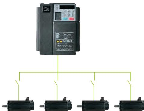
Управление до 4 моторов с разным временным разделением в SVC режиме
